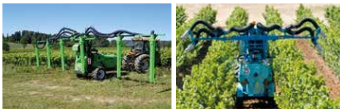
Σχ. 23: Πολύστοιχος ψεκαστήρας α) με ακροφύσια, β) με στόμια
