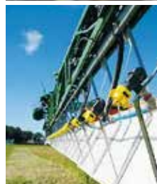
Σχ. 20: Ο καμπτήρας φυτείας/ Tilter ανοίγει το φύλλωμα της φυτείας για την καλύτερη διείσδυση του ψεκαστικού νέφους.
