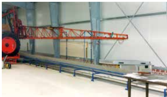
Σχ. 17: Εξοπλισμός για τη μέτρηση της ποιότητας της διασταυρωτής κατανομής του ψεκαστικού διαλύματος.
