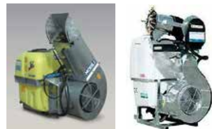
Σχ. 27: Ψεκαστήρας «κανονιού» πολύ ευάλωτος στη διασπορά του ψεκαστικού νέφους
