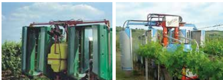
Σχ. 28: Ψεκαστήρες σήραγγας
